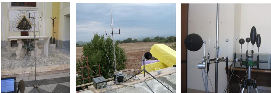
Figura 1 – Impiego in campo della Centralina Microclimatica INNOVA 1221.
