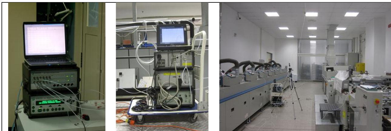
Figura 2 – Impiego in campo dell’analizzatore fotoacustico INNOVA 1412 per la misura dell’efficienza di ventilazione.
