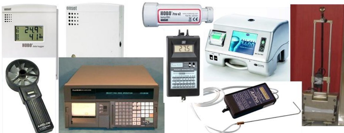
Figura 5– Piccola strumentazione portatile per la misura di parametri necessari alla valutazione della IEQ.
