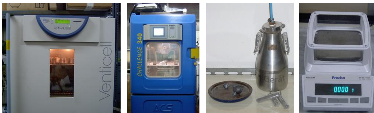
Figura 4 – Stufa a ventilazione forzata, camera climatica, bottiglia al carburo di calcio e bilancia analitica per la misura del contenuto d’acqua e dell’umidità di equilibrio in campioni di muratura.
