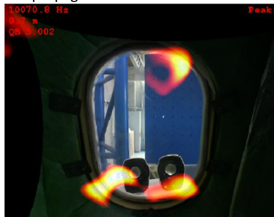
Zone di localizzazione del leakage acustico
